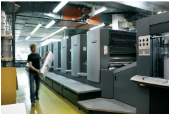
Im Drucksaal produzieren eine Speedmaster CD 102-6, eine SM 102-10-P6, eine SM 102-2-P und die SM 52-5 mit Anicolor-Farbwerk.
