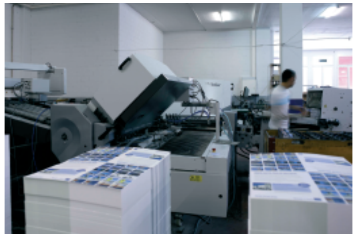
Zwei Polar Schneidstraßen und eine Schneidmaschine, zwei MBO-Falzmaschinen sowie ein Stahlfolder TH82.6/82.6-PFH82 und eine Stahl T 36/4 KB 36 sowie ein Sammelhefter mit 6 Stationen oder 5 Stationen und Umschlaganleger sorgen für die
